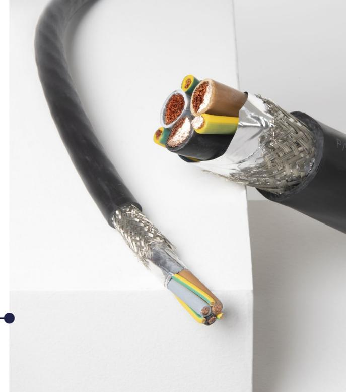
La guaina è nera in **PVC**, gli isolamenti in **XLPE** e la tensione di esercizio **1000V** per essere impiegati in installazione statica in ambienti con temperature fino a **90°C**.
