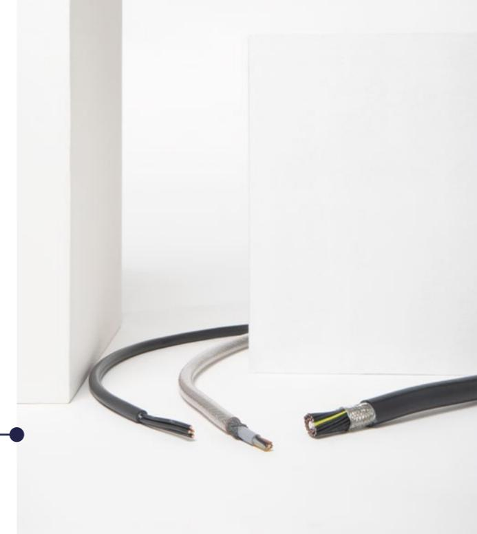
I cavi **Tecniflex® BK 0,6/1 KV** sono multipolari con tensione di esercizio Uo/U **600/1000V (in guaina nera)**. Sono certificati CPR, classe Eca, e sono caratterizzati da un'**alta resistenza agli agenti atmosferici**. Nella **versione schermata**, realizzata per i mercati esteri, questi cavi sono dotati di una **guaina intermedia**. Questi prodotti sono ritardanti alla fiamma secondo le normative IEC 60332-1-2 / DIN EN 60332-1-2
