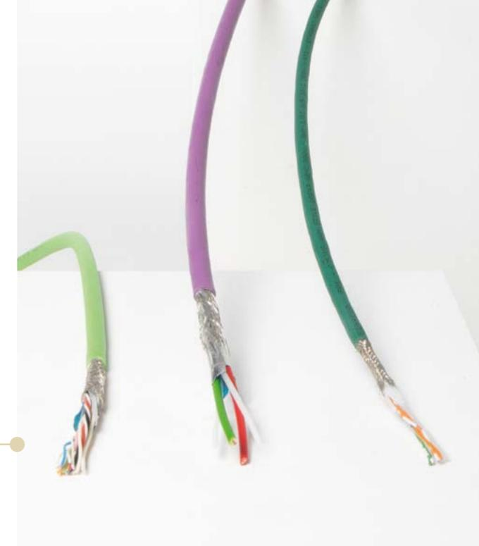
Diversi **cavi DATI** presentano tensione di isolamento pari a **1000V** e – per un ingombro ridotto – disposizione delle coppie di conduttori a quarta. I cavi DATI per posa mobile appartengono alle famiglie **FRX®** e **PMXX®**, per l'utilizzo in catene portacavi. Il loro impiego è fondamentale per la semplificazione del cablaggio e la gestione di una linea produttiva. Il portafoglio TECO include: **Ethernet industriali** e **BUS seriali**.
